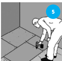
Skru platene direkte i underlaget. Ingen forboring er nødvendig. Anvend AQUAPANEL® Maxiskrue SN25. 9 skruer pr plate. Skruavstand minst 15 mm fra kanten.
