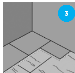
Start med å legge platene fra et hjørne og jobb deg ut i rommet. Platene kan monteres på langs eller på tvers, avhengig av hva som er mest hensiktsmessig.
