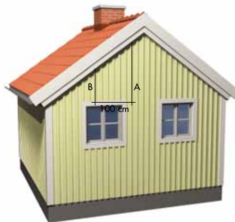
Bilde 1. Mål A minus mål B gir grunnlaget for beregning av husets takvinkel.
