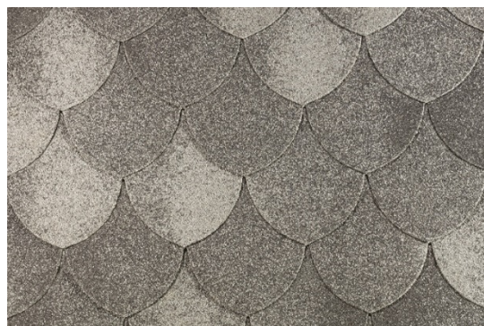
Fig. 3 Takshingel Valdres – buet. Bredde: 1,0 m oppdelt i 4 tunger. Hver shingelrad bygger 143 mm. Figur: BMI Norge AS
