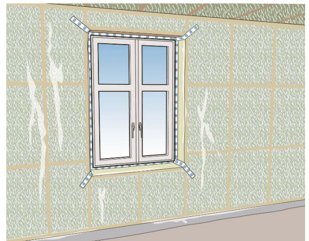
Fig. 1 Icopal Universaltape FT brukt til forsegling av skjøter i dampsperre- eller vindsperresjiktet.
