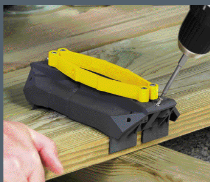
FAST DECK TOOL plasseres på terrassebordet, sentrert over bærebjelken. Skruene skrues deretter i de rake skrueshullene på verktøyet.
