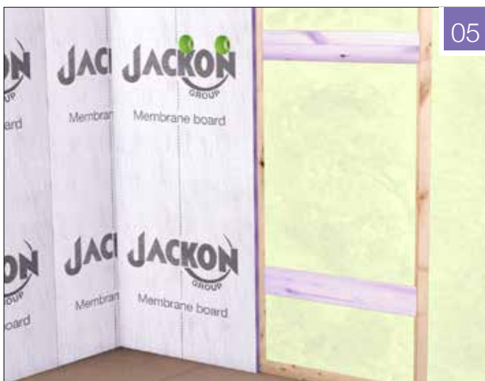
Fig. 05: Husk å forsterke med ekstra spikerslag bak tyngre gjenstander før platene monteres på vegg.
