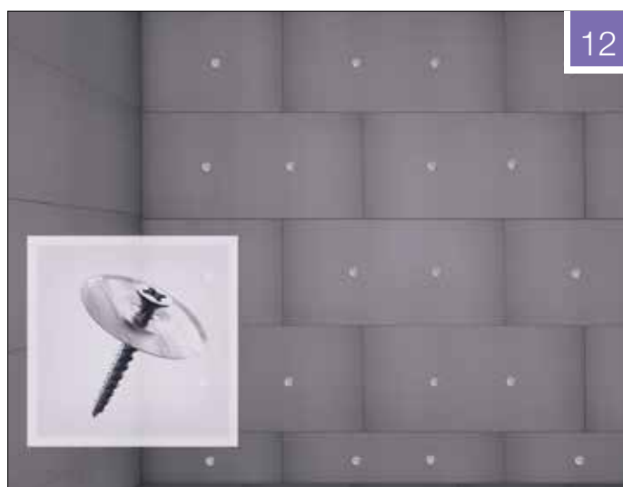
Fig. 12: Jackoboard Våtromsplate kan monteres på de fleste typer underlag, som spon eller betong. Ved montering på gulv kan det brukes plater ned til 6 mm tykkelse. Tykkere plater kan velges dersom man ønsker mer isolasjon i gulvet.
