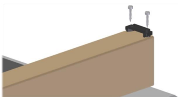
Figur 1: Monter en holder på hver bjelke
