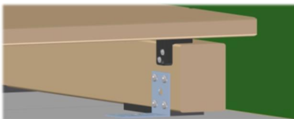
Figur 8: Skru endeklipset fast til underkonstruksjonen.
