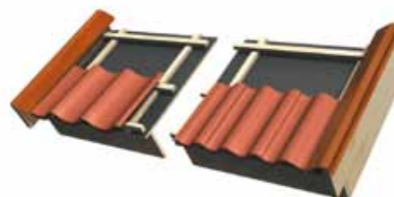
Bilde 6. Byggebredde for Hansa er ca 211 mm, Tvilling 344 mm og Piano 204 mm. Pass på at vindskibeslaget ligger over taksteinen, slik at vannet ledes ned i taksteinens bølge.
