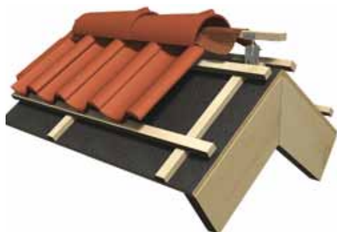
Bilde 10. Det er viktig at møne og valmtettingsrullen ikke ligger mot sidene på mønekammen, kun på toppen. Da får du best utluffing.
