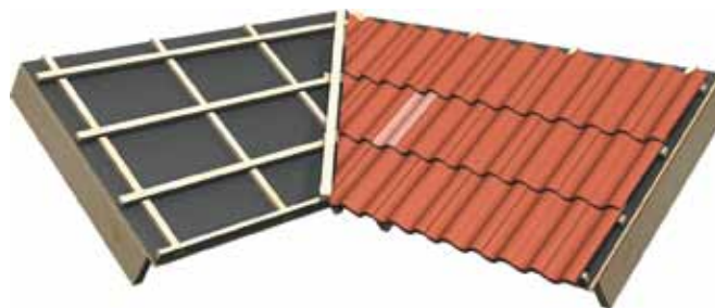
Bilde 13. Gradrenne ved bruk av Hansa gradrennestein og Tvilling halvstein.
